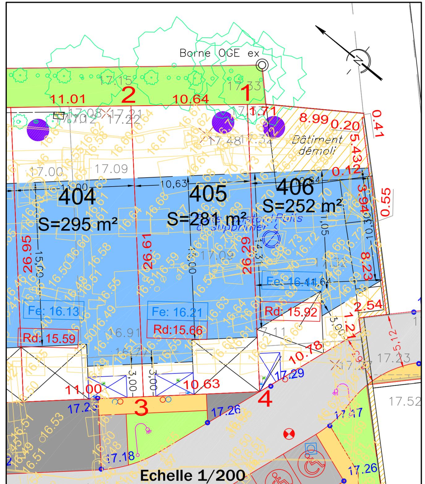
ALTITUDE DES OUVRAGES APRES REALISATION DES TRAVAUX
