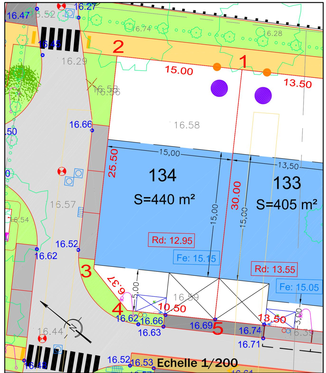
ALTITUDE DES OUVRAGES APRES REALISATION DES TRAVAUX
