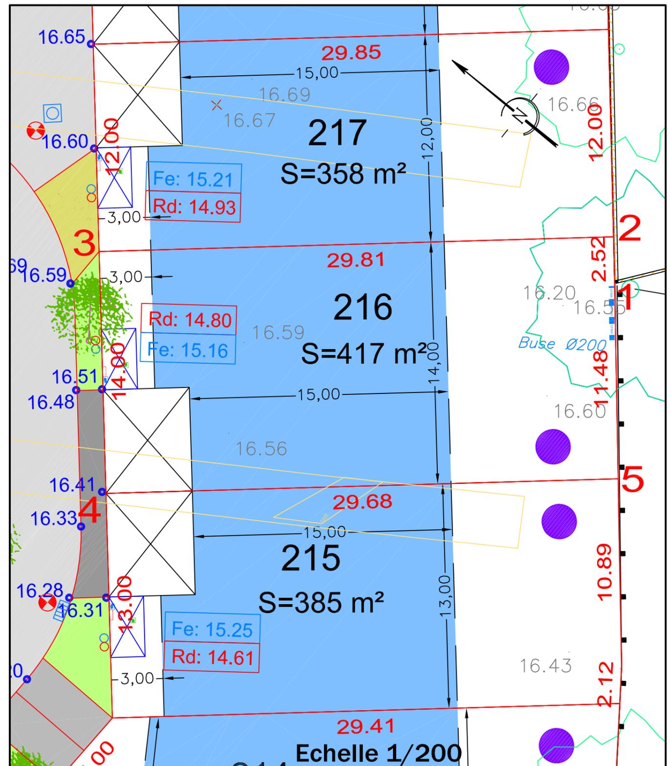
ALTITUDE DES OUVRAGES APRES REALISATION DES TRAVAUX
