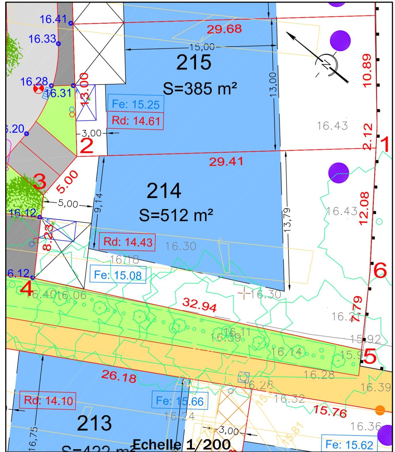
ALTITUDE DES OUVRAGES APRES REALISATION DES TRAVAUX
