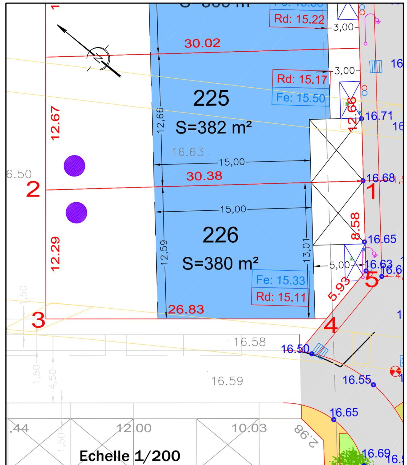
ALTITUDE DES OUVRAGES APRES REALISATION DES TRAVAUX
