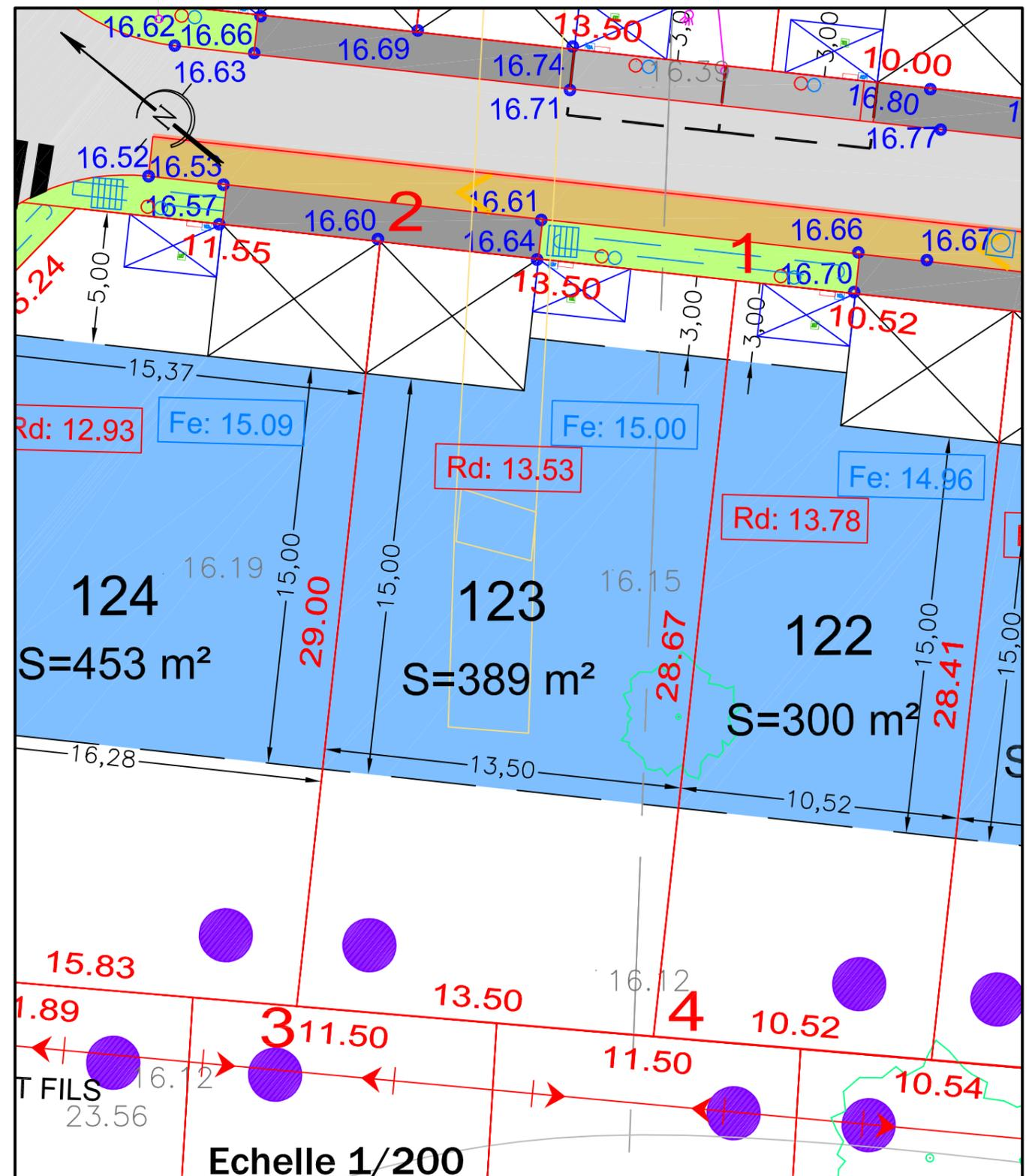
ALTITUDE DES OUVRAGES APRES REALISATION DES TRAVAUX
