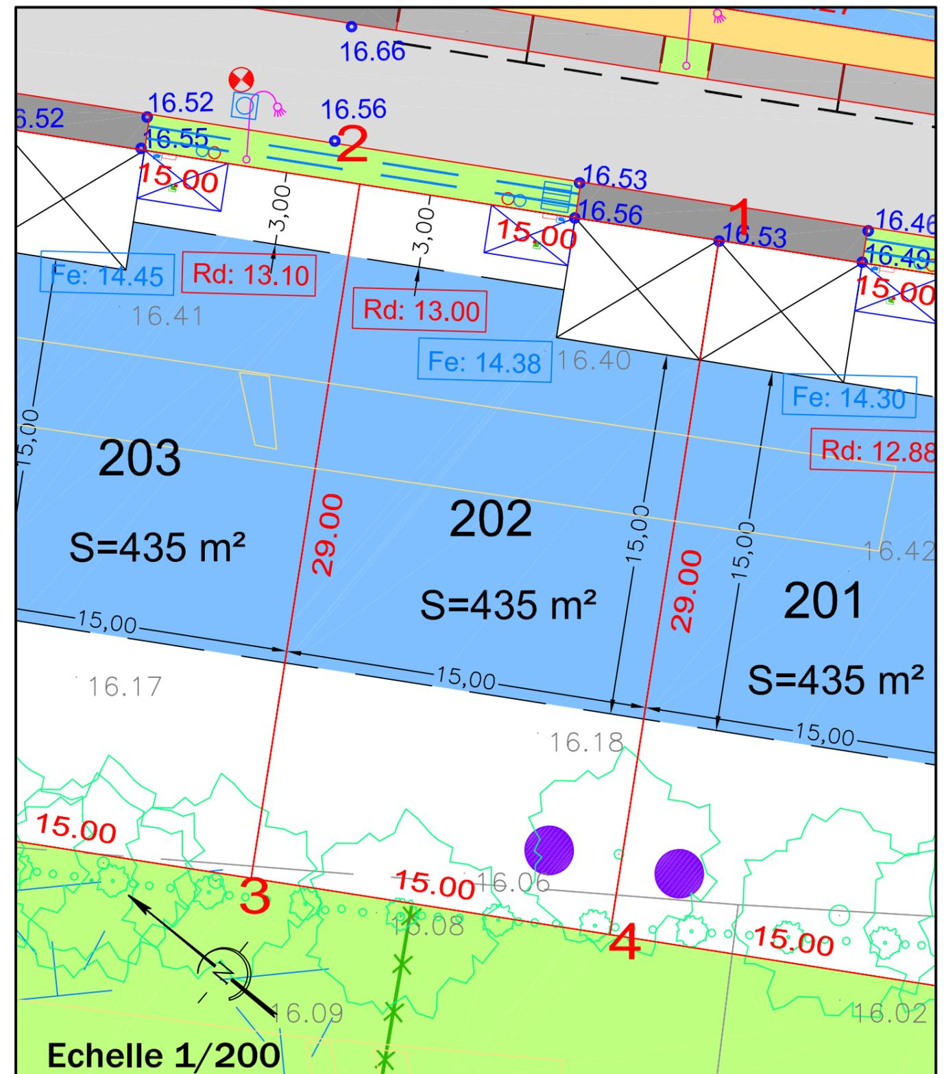
ALTITUDE DES OUVRAGES APRES REALISATION DES TRAVAUX
