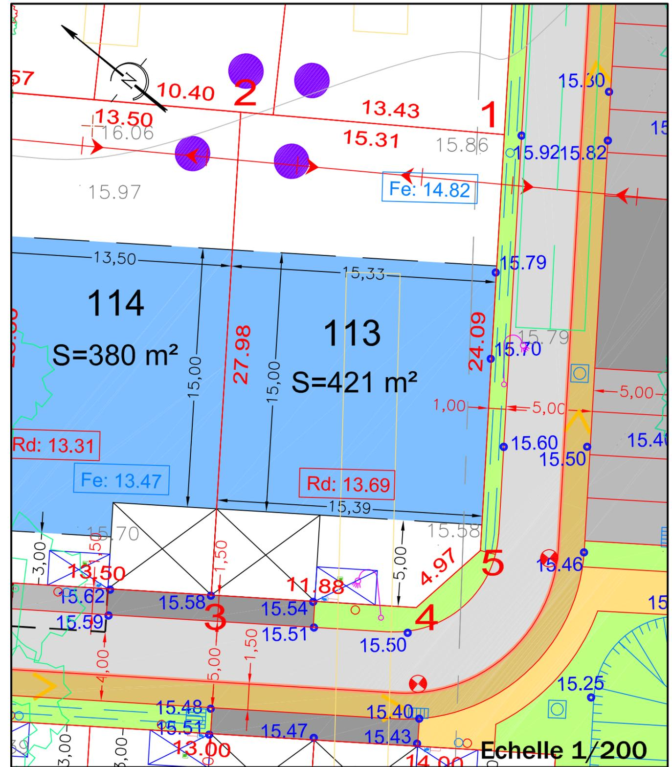
ALTITUDE DES OUVRAGES APRES REALISATION DES TRAVAUX
