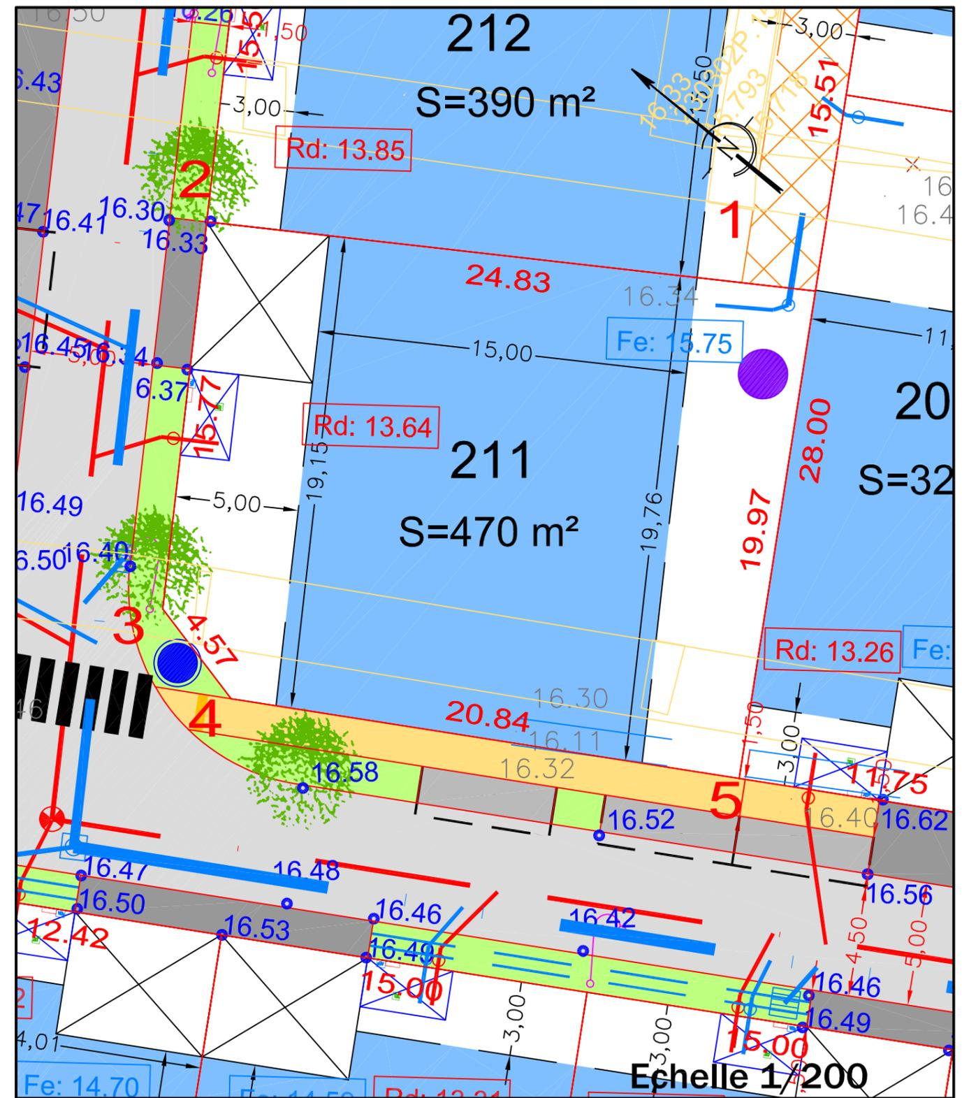
ALTITUDE DES OUVRAGES APRES REALISATION DES TRAVAUX
