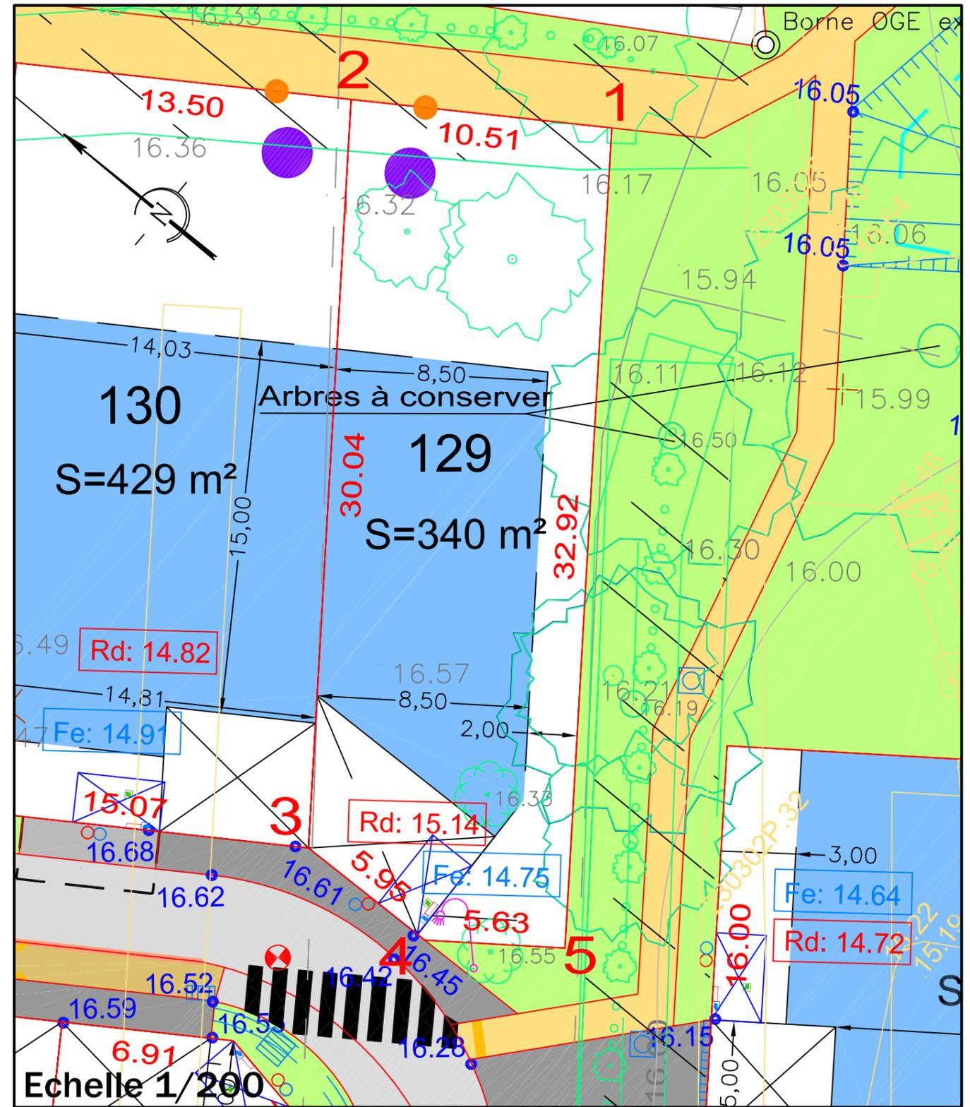
ALTITUDE DES OUVRAGES APRES REALISATION DES TRAVAUX
