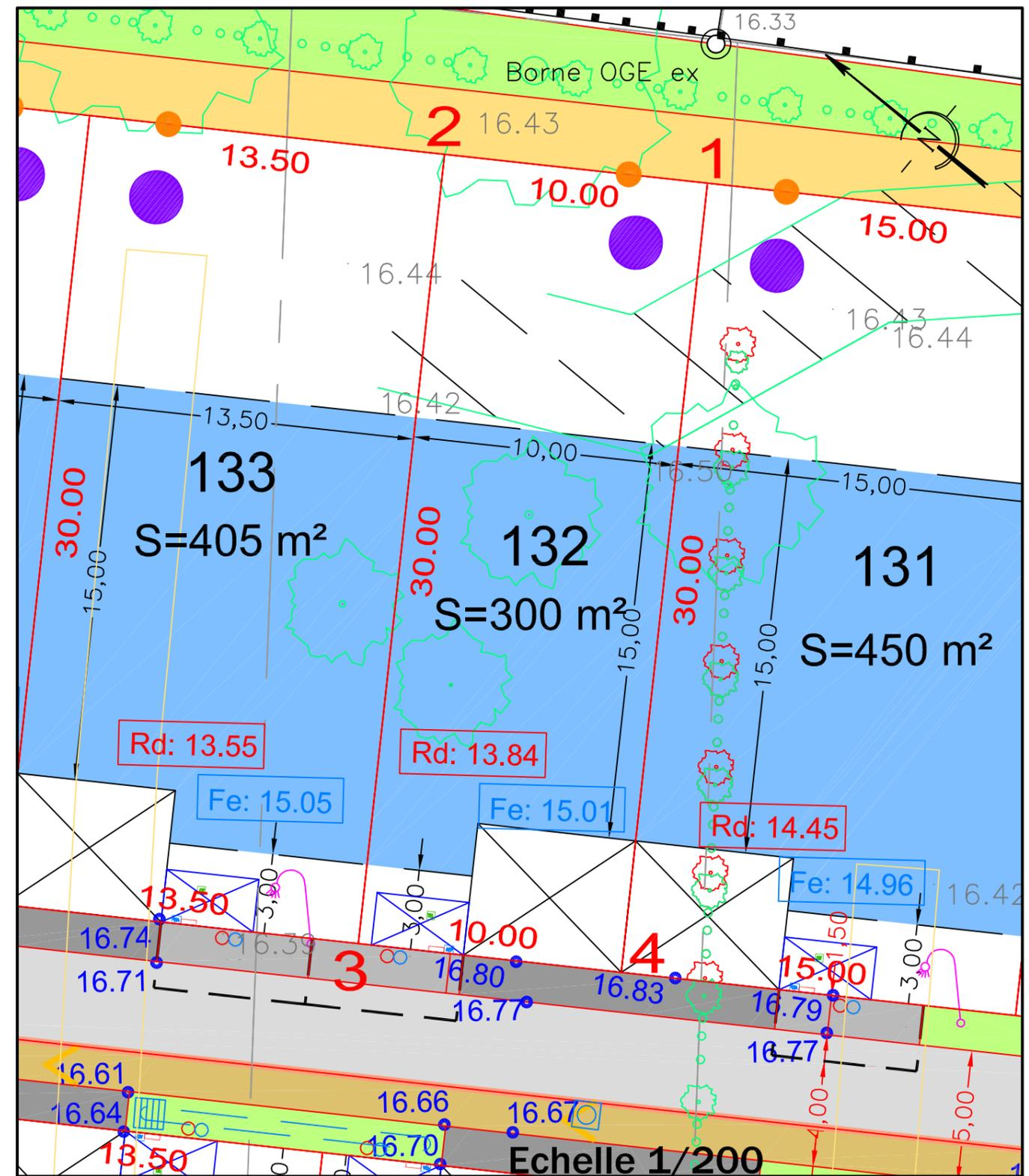
ALTITUDE DES OUVRAGES APRES REALISATION DES TRAVAUX
