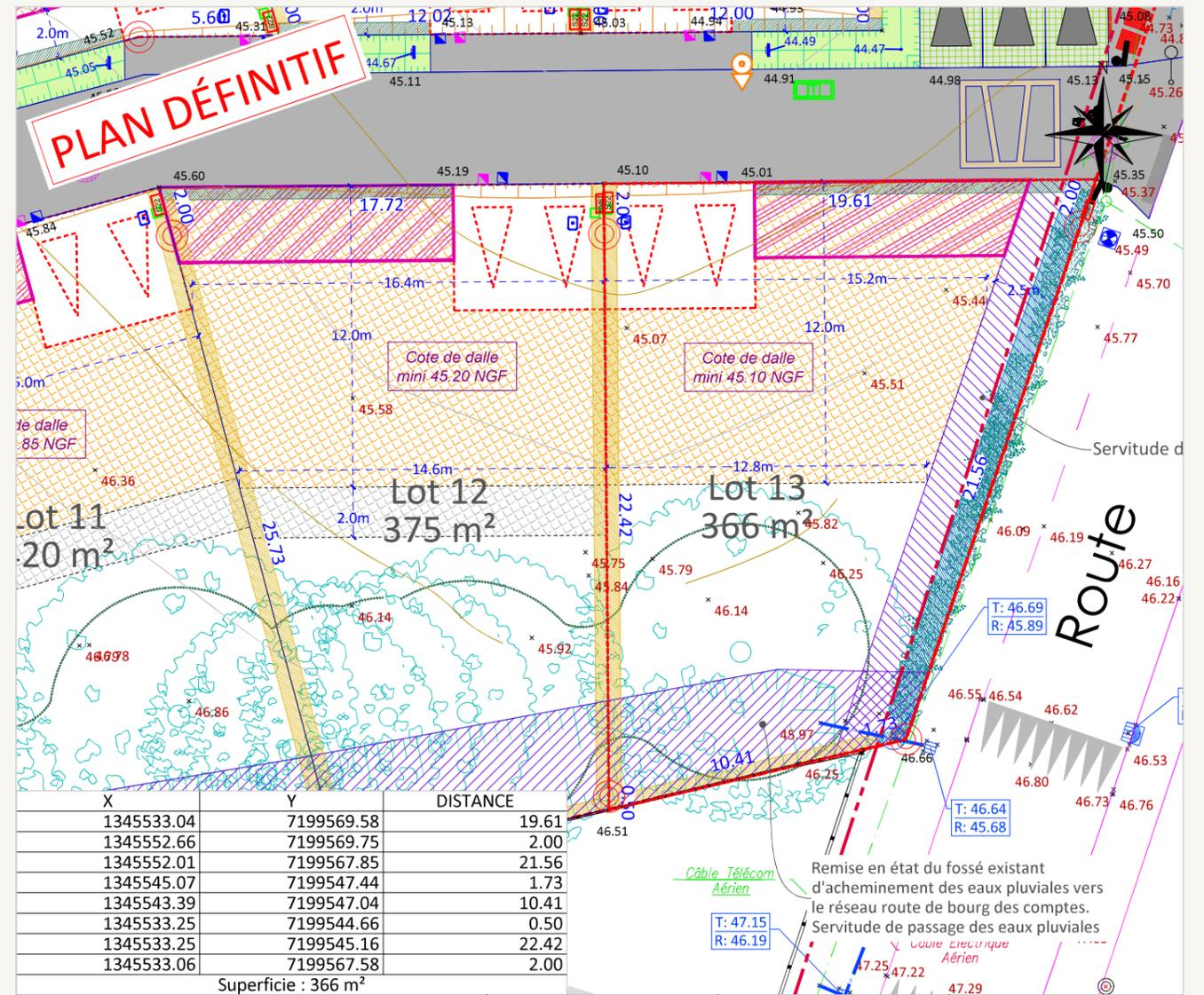
Rattachement planimétrique: RGF93 CC47 Fil d'eau EP: 44.57 Fil d'eau EU: 44.29 Echelle: 1/250
